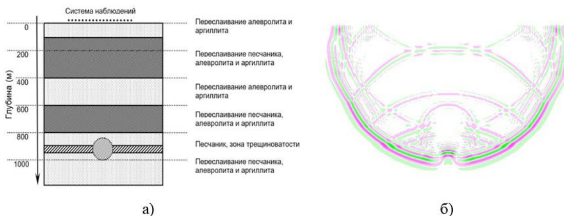
Рис. 1. Модель разрезов на участке «Кальмиусский Рудник» поля шахты им. А.Ф. Засядько (а) и мгновенная картина распространения SH волн (б)
