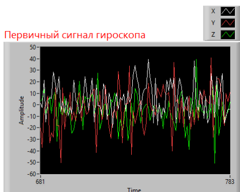
Рис. 3. Результаты исследований модуля MPU-6050
