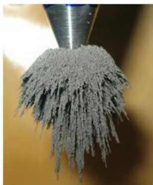
Рис. 2. Структура КМАП в магнитном поле установки по измерению магнитно-массовой пробы
