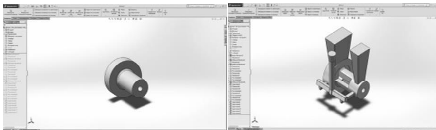
Рис. 2 – Трехмерные модели отливки в Solidworks Flow Simulation
