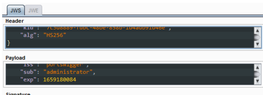
Рис. 2. Подмена алгоритма подписи в перехваченном пакете с помощью расширения JWT Editor для Burp Suite
