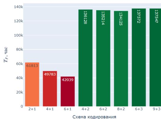
Рисунок 5. Зависимость среднего времени наработки на отказ от используемой схемы при средней нагрузке 1 Гбит/с.
