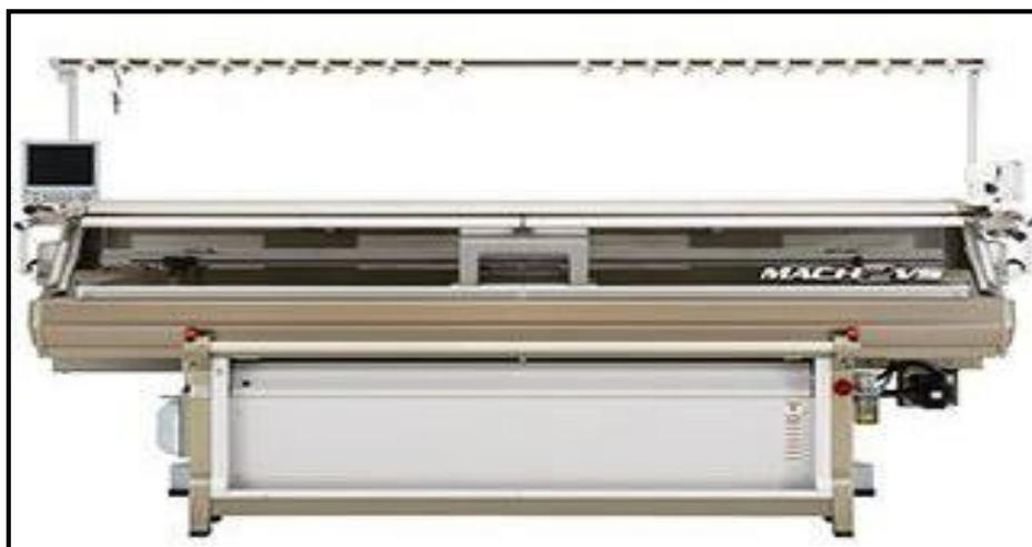
Рисунок 2. Автоматизированная плосковязальная машинка “Shima Seiki”.
