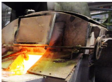
Рисунок 2. Процесс литья алюминия в прессформы [3].
