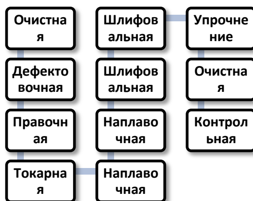
Рисунок 1. Схема ремонта коленчатого вала.
