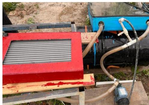
Рисунок 2– Сборка тепловентилятора с солнечным коллектором
