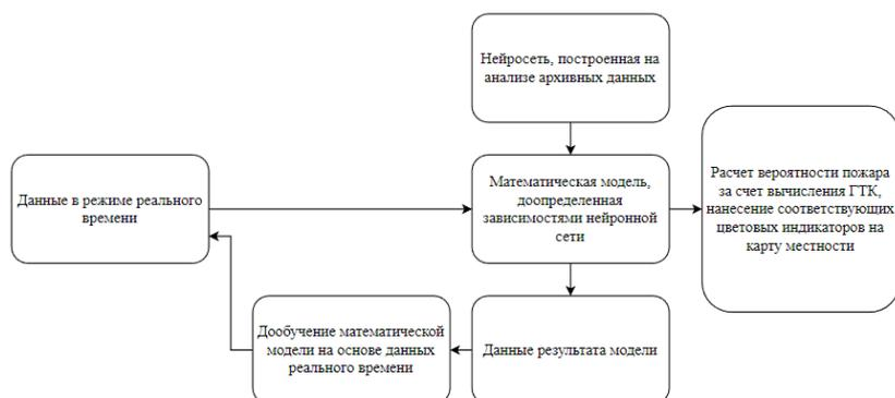
Рисунок 1. Блок-схема с нейронной сетью для прогнозирования засух.
