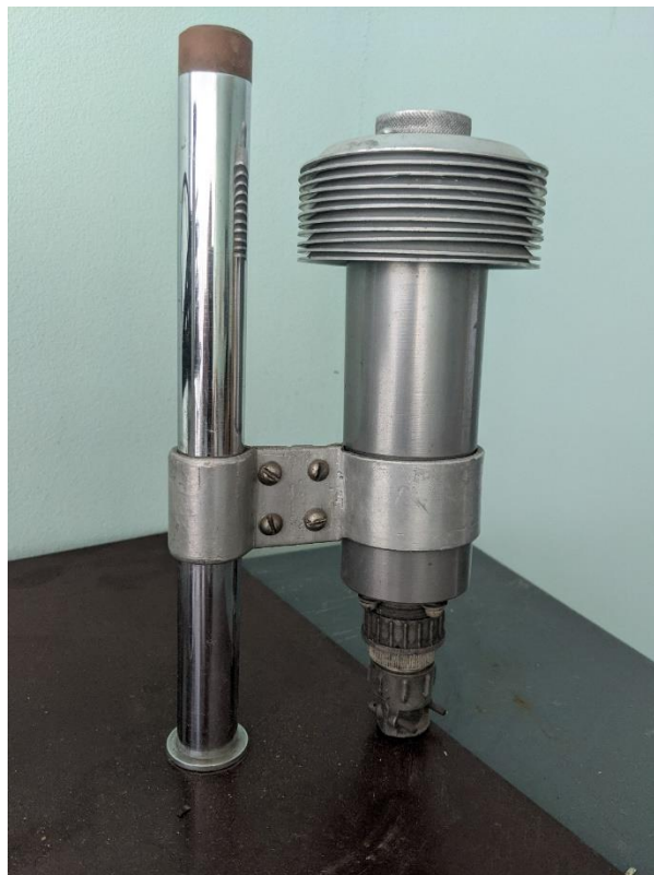
Рисунок 2. Внешний вид конструкции стационарного варианта измерителя влажности для натуральных морских исследований
