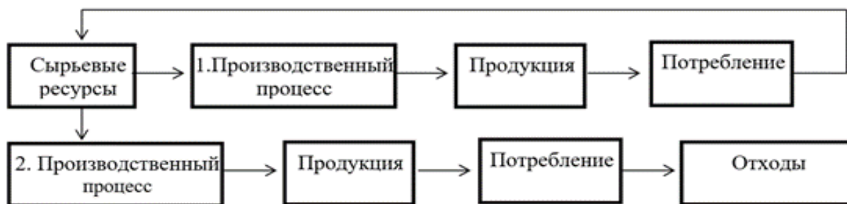
Рис. 1. Схема замкнутого цикла производства
